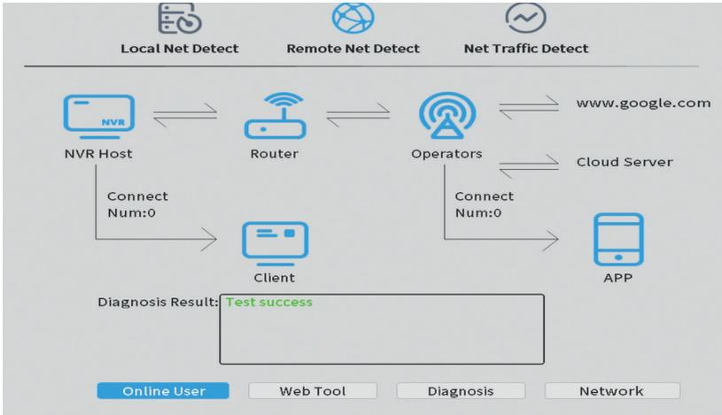
**3. Net traffic Detect.** Monitoraggio del traffico dati eseguito da NVR in rete.
