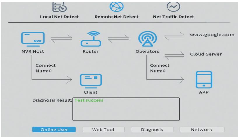
**3. Net traffic Detect.** Мониторинг на трафика на данни, извършван от NVR в мрежата.
