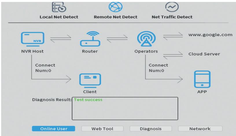
**3. Net traffic Detect.** Monitoring van dataverkeer uitgevoerd door NVR in het netwerk.
