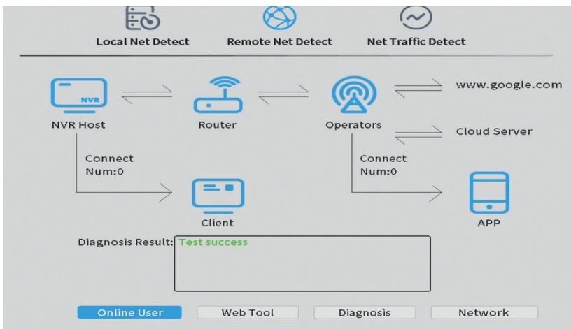
**3. Net traffic Detect.** Monitorowanie ruchu danych realizowanego przez NVR w sieci.
