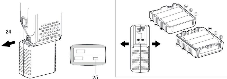
**24. Batteriefach (optionales Zubehör, nicht im Lieferumfang enthalten):** Fügen Sie 6 Ni-Cadmium-Alkalibatterien hinzu
