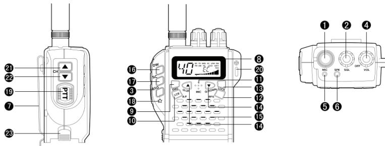
**1. Antenna csatlakozás:** Helyezze el a kompatibilis antennát ( a csomag nem tartalmazza). A jobb minőség elérése érdekében külső antennát is használhat, amely a csomagban található adapterre rögzíthető.
