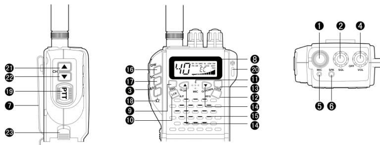
**1. Connettore BNC per l'antenna:** fissare un'antenna compatibile (non inclusa nella confezione). Per ottenere prestazioni migliori, è possibile utilizzare un'antenna esterna che si inserisce nell'adattatore incluso
