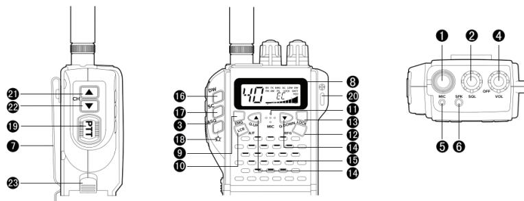
**1. BNC Konnektor für die Antenne:** befestigen Sie eine kompatible Antenne (ist nicht inbegriffen). Für bessere Leistungen benutzen Sie eine externe Antenne, die Sie am Konnektor anschließen.
