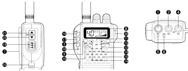
**1. Le connecteur BNC pour l'antenne:** attachez une antenne compatible (n'est pas inclue dans le paquet). Pour avoir les meilleures performances, vous pouvez utiliser une antenne externe qui sera connectee a l'adaptateur inclu.
