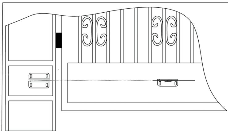
Assurez-vous que la hauteur d'installation du support arrière est égale à la hauteur d'installation du support avant. La réalisation d'un assemblage basé sur des mesures inexactes peut entraîner des problèmes de fonctionnement du bras de piston. De plus, la force d'ouverture et de fermeture sera réduite. De grandes différences de hauteur entre les deux supports peuvent même brûler le moteur et le bras de piston.
