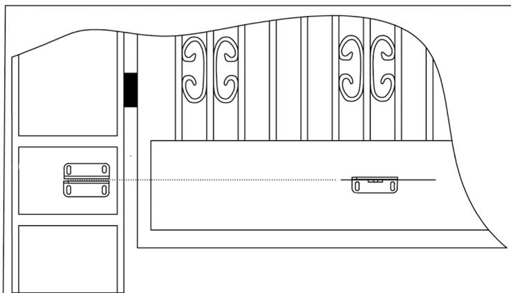
Győződjön meg arról, hogy a hátsó konzol felszerelési magassága megegyezik az első konzol beépítési magasságával. A pontatlan mérések alapján végzett szerelés problémákat okozhat a dugattyúkar működésében. Emellett csökken a nyitó és záró erő. A két tartó közötti nagy magasságkülönbség akár meg is égetheti a motort és a dugattyú kart.
