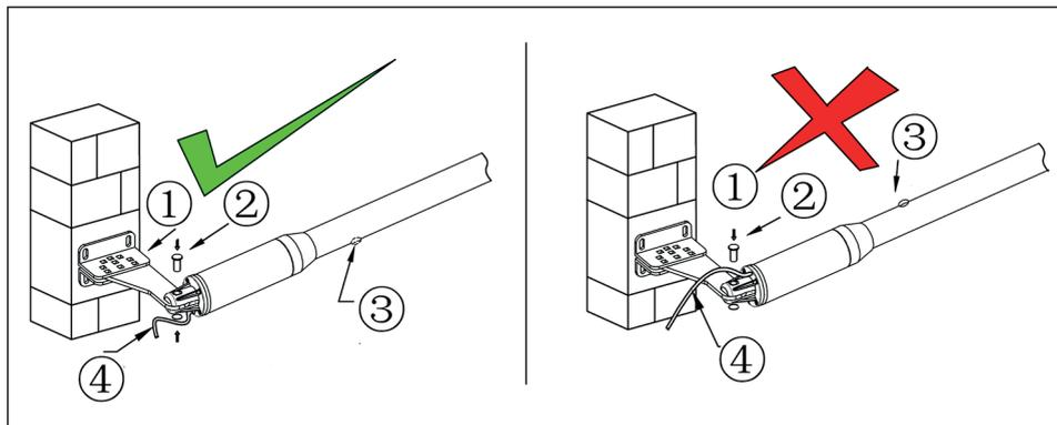
Linker afbeelding: het netsnoer en het afvoergat zijn correct gepositioneerd.
