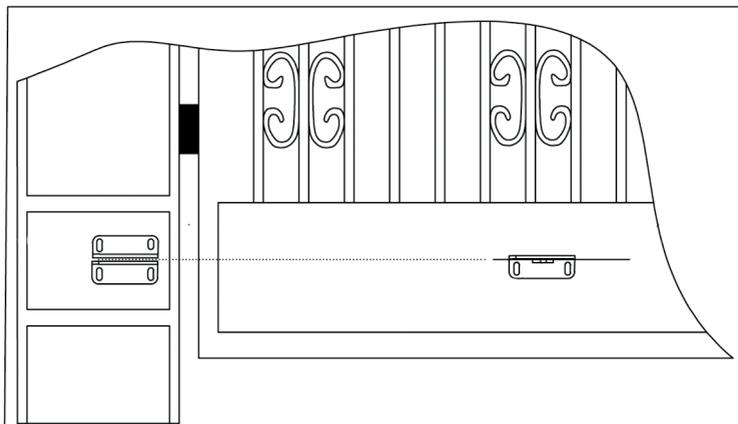
Уверете се, че височината на монтаж на задната скоба е равна на височината на монтаж на предната скоба. Извършването на монтаж въз основа на неточни измервания може да доведе до проблеми в работата на рамото на буталото. Освен това силата на отваряне и затваряне ще бъде намалена. Големите разлики във височината между двете скоби могат дори да изгорят двигателя и рамото на буталото.
