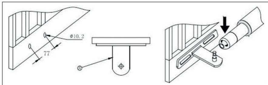
1. Percer dans la porte 2 trous de 10,2 mm chacun à une distance de 68 mm l'un de l'autre.
