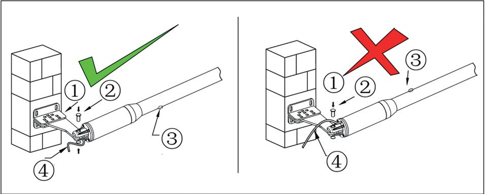
**L'immagine a sinistra:** il cavo di alimentazione e il foro di scarico sono posizionati correttamente.
