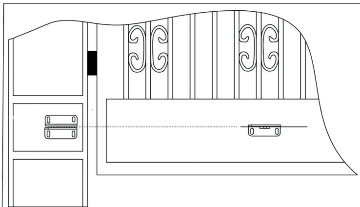
Zorg ervoor dat de montagehoogte van de achterste beugel gelijk is aan de montagehoogte van de voorste beugel. Het uitvoeren van een montage op basis van onnauwkeurige metingen kan leiden tot problemen bij de werking van de zuigerarm. Ook wordt de openings- en sluitkracht verminderd. Grote hoogteverschillen tussen de twee beugels kunnen zelfs de motor en de zuigerarm verbranden.
