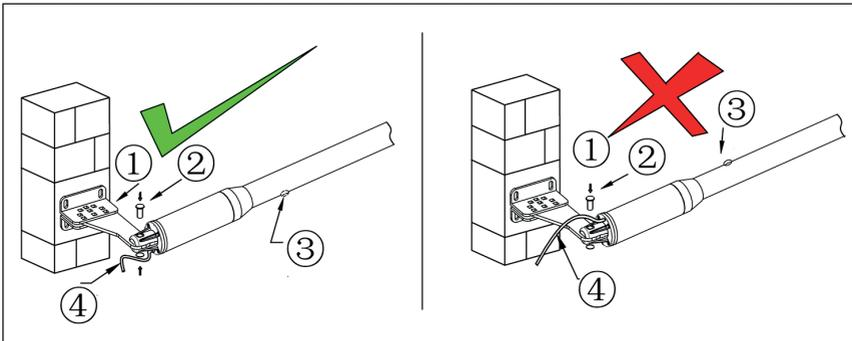
**Imaginea din stanga:** cablul de alimentare si orificiul de drenaj amplasate corect.
