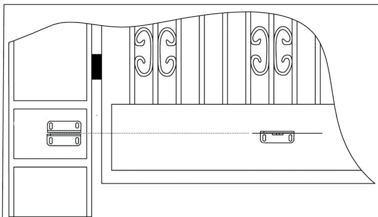
Upewnij się, że wysokość montażu kątownika bramy jest równa wysokości montażowej kątownika bramy. Przeprowadzenie montażu na podstawie niedokładnych pomiarów może prowadzić do problemów w działaniu silnika tłokowego. Zmniejszy się również siła otwierania i zamykania bramy. Duże różnice wysokości między dwoma wspornikami mogą nawet doprowadzić do spalania silnika i ramienia tłoka.
