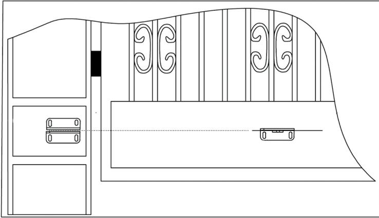
Asigurati-va ca inaltimea de instalare a suportului de pe stalpul portii este egala cu inaltimea de instalare a suportului de pe poarta. Realizarea unui montaj pe baza unor masuratori imprecise poate duce la probleme in functionarea motorului cu piston. De asemenea, forta de deschidere si inchidere a portii va fi redusa. Diferente mari de inaltime intre cei doi suportii pot duce chiar la arderea motorului si a bratului cu piston.
