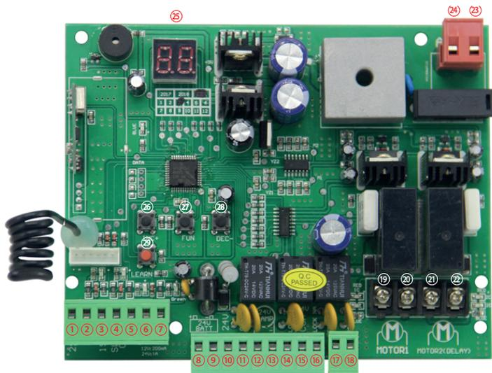
1. 2SIDE+COM: per il collegamento di qualsiasi dispositivo esterno che controlla doppi cancelli. (relè non alimentato)
