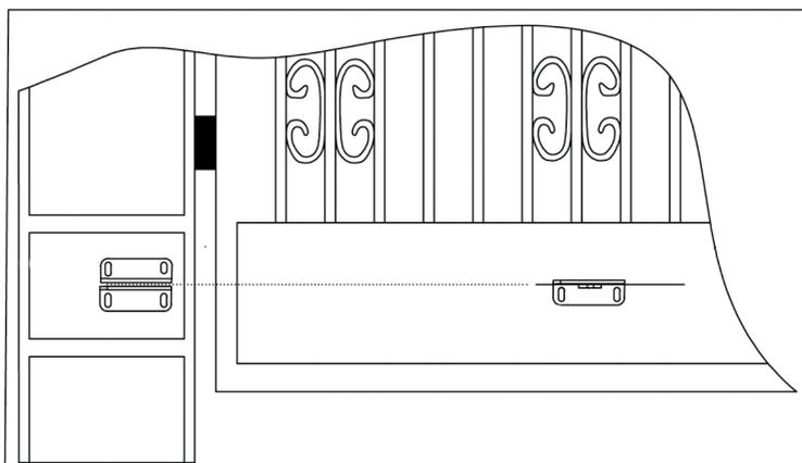
Assicurarsi che l'altezza di installazione del supporto sul palo del cancello sia uguale all'altezza di installazione del supporto sul cancello. L'esecuzione di un assemblaggio basato su misurazioni imprecise può portare a problemi nel funzionamento del motore a pistoni. Inoltre, la forza di apertura e chiusura del cancello sarà ridotta. Grandi differenze di altezza tra i due supporti possono persino bruciare il motore e il braccio del pistone.
