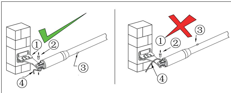
Imagen de la izquierda: el cable de alimentación y el orificio de drenaje están correctamente colocados.
