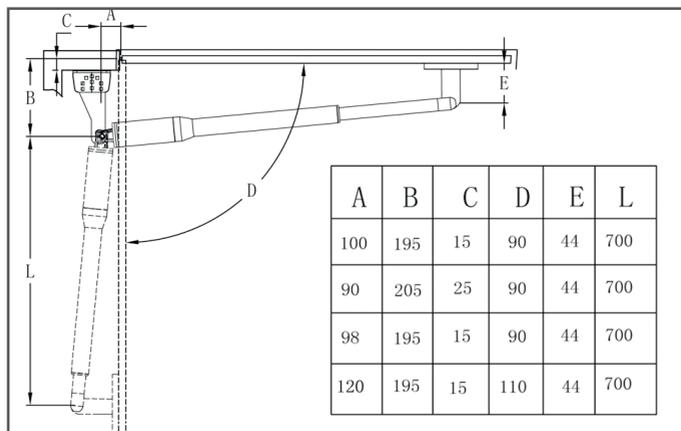
I valori delle colonne A, B, C, E e L sono espressi in mm.
