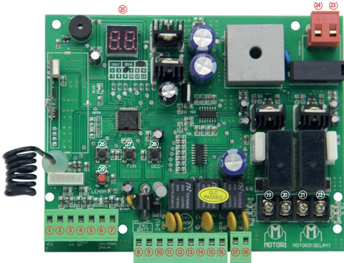
1. 2SIDE+COM: bármilyen külső eszköz csatlakoztatásához, amely kettős kapukat vezérel. (feszültség nélküli relé)
