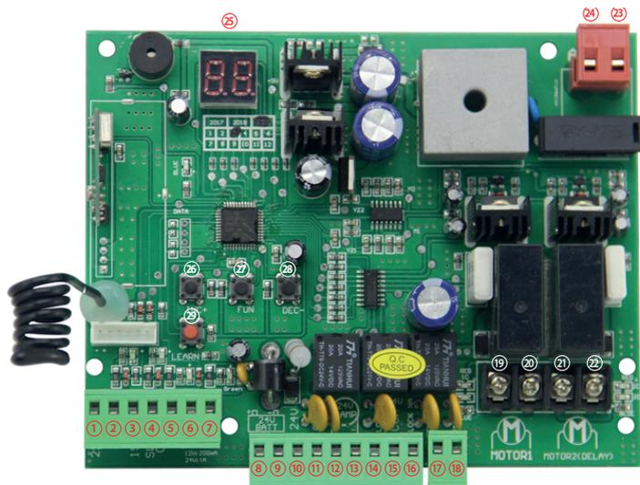
1. 2SIDE+COM: do podłączenia dowolnego urządzenia zewnętrznego sterującego bramami podwójnymi. (przełącznik niezasilany)
