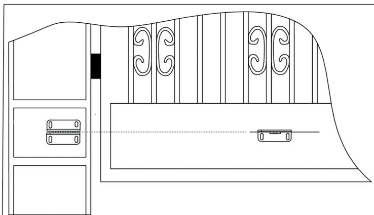
Asegúrese de que la altura de instalación del soporte trasero sea igual a la altura de instalación del soporte delantero. Realizar un montaje basado en mediciones inexactas puede provocar problemas en el funcionamiento del brazo del pistón. Además, se reducirá la fuerza de apertura y cierre. Las grandes diferencias de altura entre los dos soportes pueden incluso quemar el motor y el brazo del pistón.
