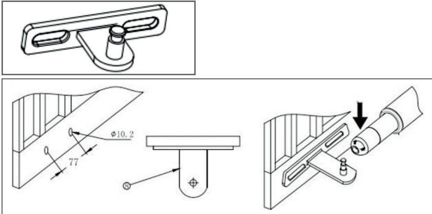
1. Bohren Sie im Tor 2 Löcher von 10.2 mm, 68 mm voneinander entfernt.
