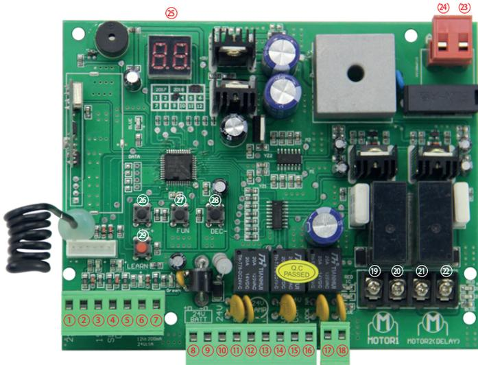
1. 2SIDE+COM: voor het aansluiten van elk extern apparaat dat dubbele poorten aanstuurt. (niet-bekrachtigd relais)
