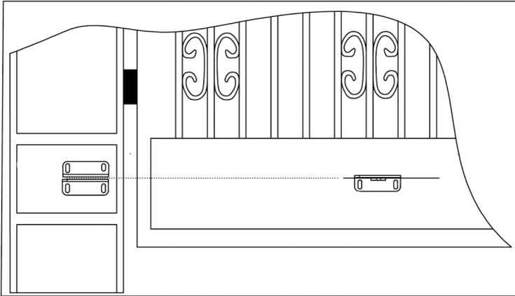
Prüfen Sie, dass die Einbauhöhe des Gestells am Mast des Tores gleich mit der Einbauhöhe des Gestells auf dem Tor ist. Wenn Sie nicht genau messen, kann das das Funktionieren des Kolbenmotors beeinträchtigen. Die Öffnungs- und die Schließkraft werden davon beeinträchtigt. Wenn die Einbauhöhen zu viel variieren, kann das zu Verbrennung des Motors und des Kolbenarms führen.
