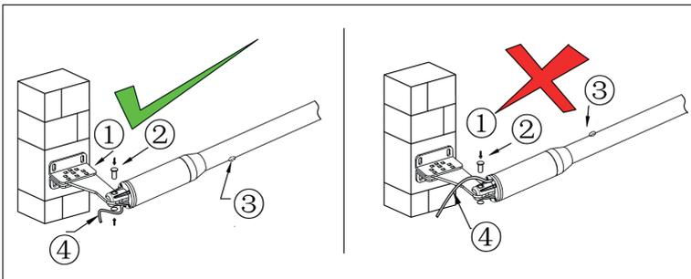
**Bild links:** das Versorgungskabel und die Drainageöffnung wurden richtig eingebaut.
