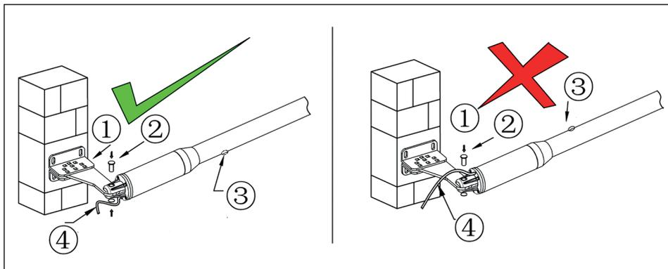
Obraz po lewej: przewód zasilający i otwór spustowy są umieszczone prawidłowo.
