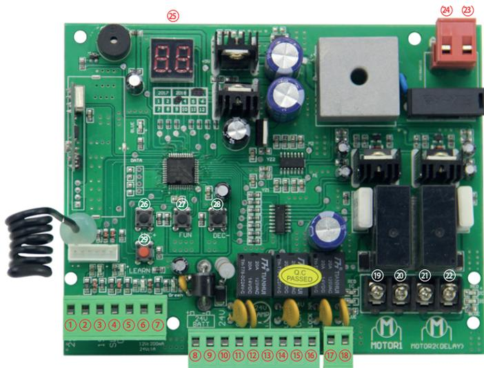
1. 2SIDE+COM: pentru conectarea oricarui dispozitiv extern care controleaza porti duble (releu ne-energizat)
