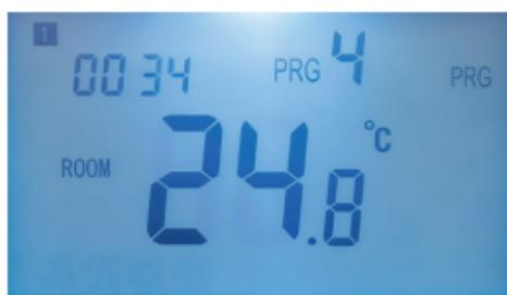
In de **handmatige modus** worden alleen de tijd, dag en temperatuur op het scherm weergegeven:
