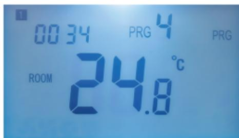
В ръчен режим на экрана се показват само час, ден и температура:
