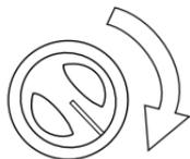
2. Tournez la commande **SQ** dans le sens horaire jusqu'à ce que le bruit disparaisse. Ceci est le seuil auquel le signal entrant est légèrement plus puissant que le bruit de fond, ce qui ouvrira la suppression du bruit de fond.
