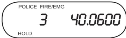
Appuyez sur la banque comprenant le canal que vous désirez effacer. L'écran affichera le premier canal programmable de cette banque. Si ce canal est *000.0000*, appuyez sur **UP** ou **DOWN** jusqu'à ce que le canal/la fréquence que vous désirez effacer apparaisse. (Dans cet exemple, le canal 3 comporte la fréquence 40.0600.)
