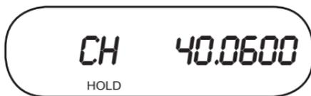
À un mode de balayage normal (une banque de canaux clignote), appuyez sur **PROG. HOLD** apparaîtra et **CH** apparaîtra et clignotera. Maintenez enfoncée **L/O** pendant 2,5 secondes.
