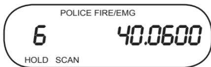
Appuyez sur **PROG**. La radio programmera la fréquence dans le canal indiqué et passera en mode SCAN HOLD.
