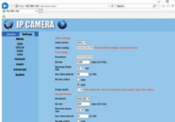
*Nota: Puteti accesa camera din internet Explorer doar daca sunteți în aceeași rețea cu camera. Dacă doriti accesarea camerei de pe computer, dar din alta rețea, instalati aplicatia HiP2P.*
