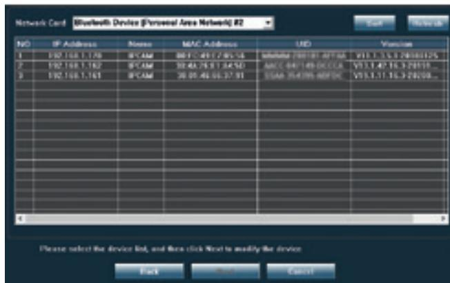
5. Clicca su **Next** per configurare i parametri di rete. È possibile inserire manualmente i parametri di rete o è possibile attivare l'opzione DHCP. Clicca su **Next**.
