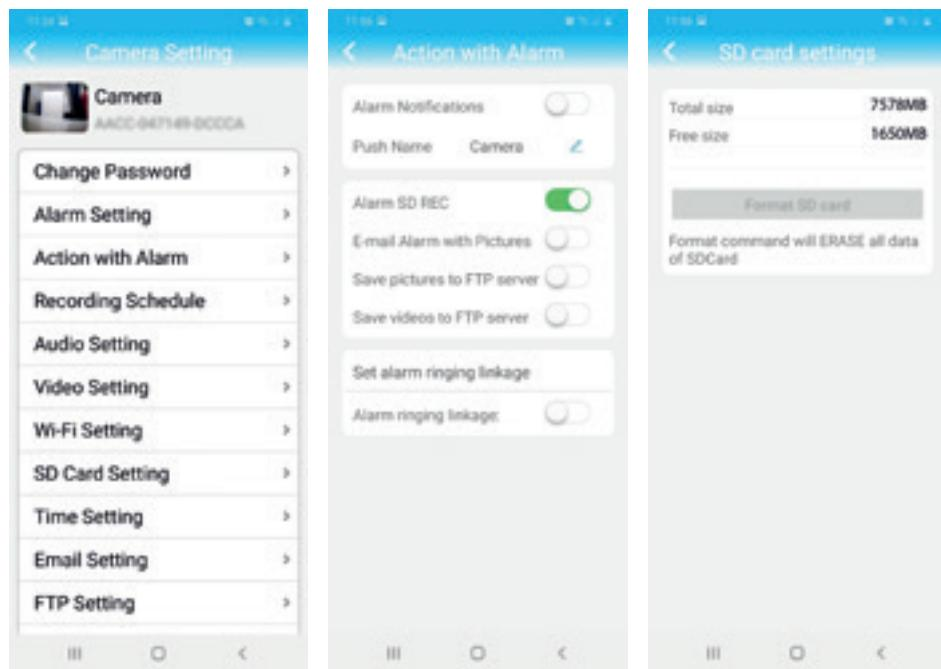
7. Om de opnamen te bekijken op de micro SD-kaart die in de camera is geïnstalleerd, drukt u op de video-optie vanaf de onderkant van de hoofdinterface van de toepassing. Selecteer de camera en het bestand dat u wilt afspelen of downloaden.
