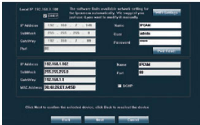
6. Open Internet Explorer en voer in de adresbalk het IP-adres van uw camera in of keer terug naar de lijst met camera's in de applicatie Serach Tool en dubbelklik op de camera die u wilt bekijken. Internet Explorer wordt automatisch geopend.
