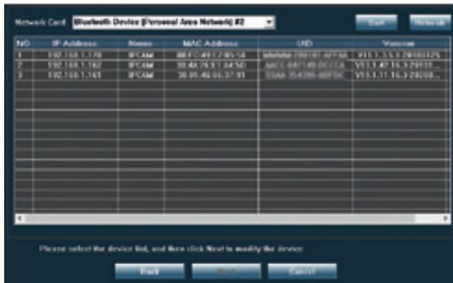
5. Faceti click pe butonul **Next** pentru a configura parametrii de retea. Puteti introduce manual parametrii de retea sau puteti bifa optiunea DHCP. Click **Next**.
