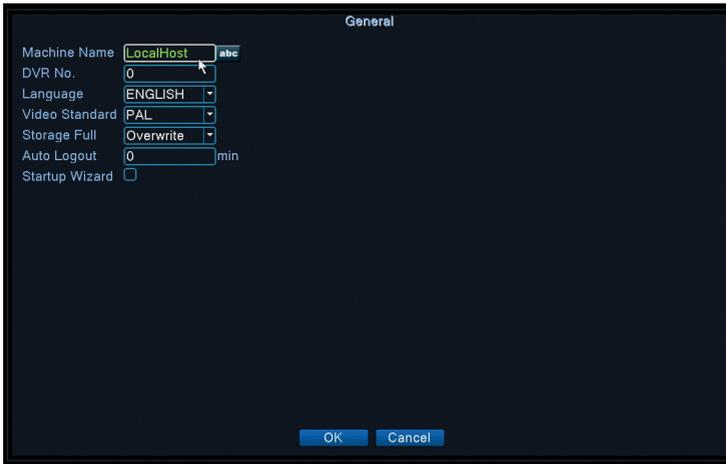
Setati numele sistemului, limba de afisare a meniului, comportamentul in caz de HDD plin (suprascriere sau oprire inregistrare), perioada de iesire automata din cont sau activati afisarea ghidului rapid de configurare la fiecare repornire a sistemului.
