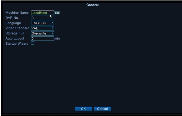
Állítsa be a rendszer nevét, a menü megjelenítési nyelvét, viselkedését teljes HDD esetén (felülírja vagy leállítja a felvételt), automatikus kijelentkezési időszakot, vagy engedélyezze a gyors telepítési útmutató megjelenítését a rendszer minden egyes újraindításakor.
