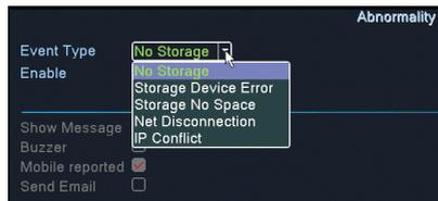
Aktivieren Sie die Alarmfunktion bei fehlendem Bild und legen Sie das Verhalten bei Alarm fest: Zeigen Sie die Alarmmeldung auf dem Bildschirm an, laden Sie sie über FTP hoch, senden Sie eine E-Mail oder eine Benachrichtigung auf dem Mobiltelefon.
