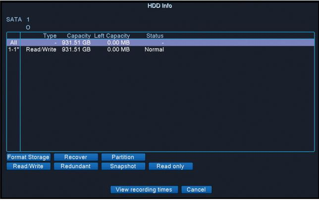
Geeft informatie weer over de capaciteit, status van de harde schijf en opties voor formattering, partitionering en toegankelijkheid (lezen/schrijven of alleen-lezen).
