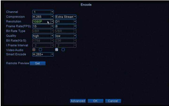
Setati diferiti parametri video precum compresie, rezolutie, cadre pe secunda (FPS) sau calitate pentru fiecare canal in parte.
