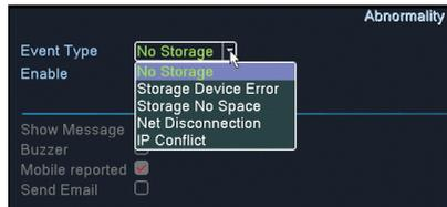
Hiányzó kép esetén aktiválja a riasztási funkciót, és állítsa be a viselkedést riasztás esetén: jelenítse meg a riasztási üzenetet a képernyőn, töltsön fel FTP-n keresztül, küldjön e-mailt vagy értesítést a mobiltelefonon.
