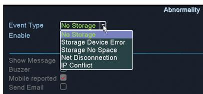
Active la función de alerta en caso de que falte una imagen y configure el comportamiento en caso de alerta: muestre el mensaje de alerta en la pantalla, cargue a través de FTP, envíe un correo electrónico o una notificación en el teléfono móvil.
