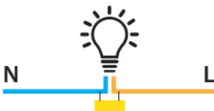
» El interruptor está instalado y conectado correctamente, pero el botón táctil no funciona. Primero asegúrese de que los cables estén conectados correctamente y que la bombilla no esté quemada.
