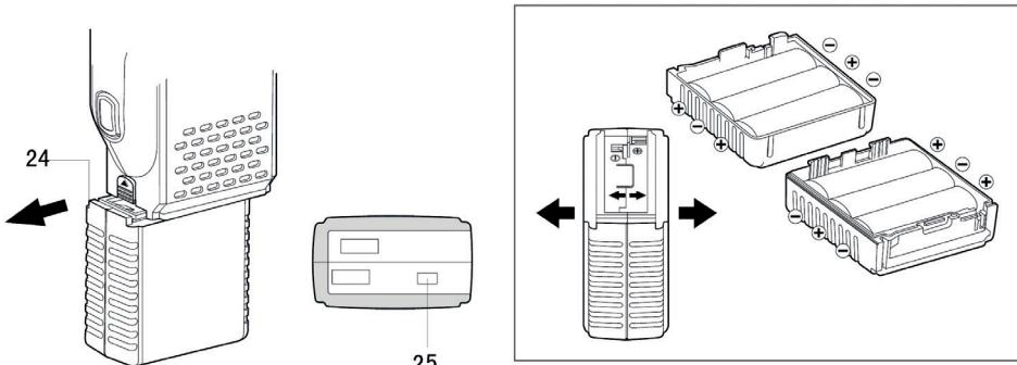
**24. Compartiment à piles (accessoire en option, non fourni): ajoutez 6 piles alcalines Ni-Cadmium**
