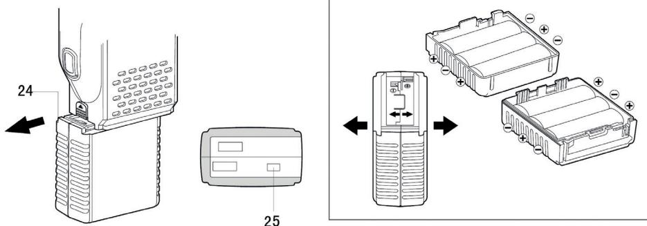
**24. Komora baterii (akcesoria opcjonalne, niedołączone): Dodaj 6 alkalicznych baterii niklowo-kadmowych**
