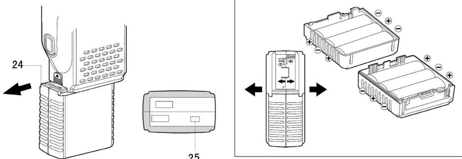
**24. Compartimiento de la batería (accesorio opcional, no incluido): agregue 6 baterías alcalinas**
