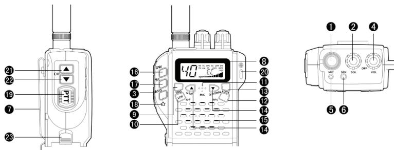
**1. Złącze anteny BNC:** podłącz kompatybilną antenę (nie ma jej w zestawie). Aby uzyskać lepszą wydajność, można użyć zewnętrznej anteny podłączanej do dołączonego adaptera
