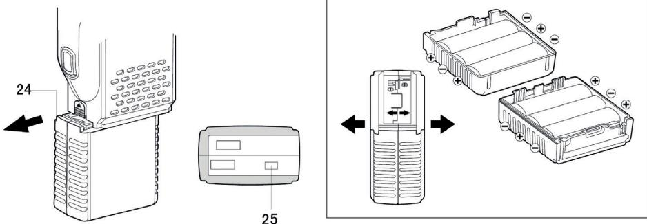
**24. Batterijvak (optioneel accessoire, niet inbegrepen):** Voeg 6 alkalinebatterijen toe.
