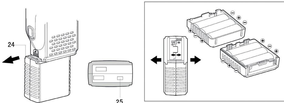
**24. Batteriefach (optionales Zubehör, nicht im Lieferumfang enthalten):** Fügen Sie 6 Ni-Cadmium-Alkalibatterien hinzu
