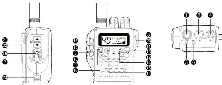
**1. BNC-antenneconnector (niet ingegeven).** Voor betere prestaties raden we aan om een externe antenne te gebruiken die wordt aangesloten op de adapter die in het pakket is meegeleverd..
