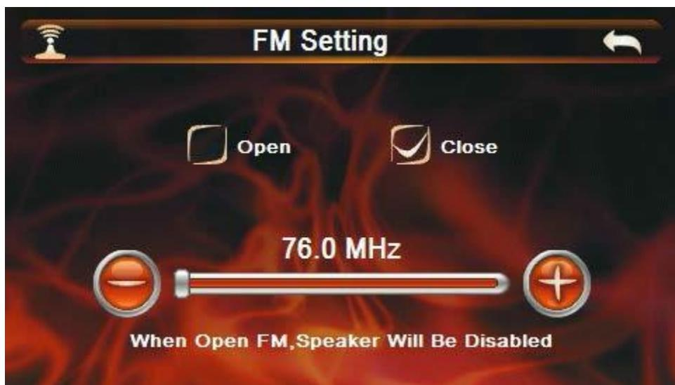
Az FM transzmitter funkciót használják az FM felvétő berendezések és a rádióállomások elérésére a navigátoron keresztül.
