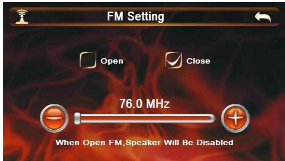
La función de transmisión FM se utiliza para acceder a un equipo de recepción FM y reproduce las emisoras de radio mediante el navegador.
