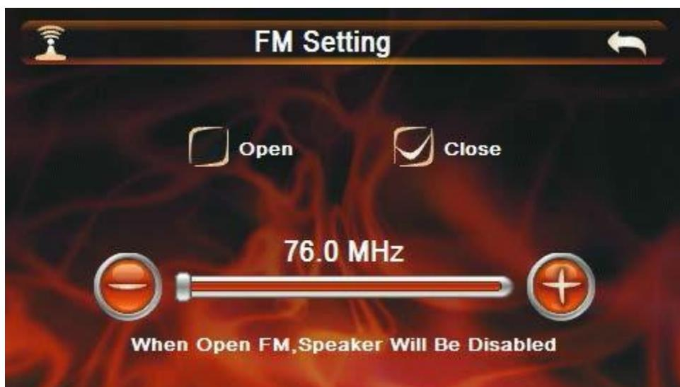
La fonction de transmission FM est utilisee pour acceder a un equipement de reception FM et pour rendre la radio par le navigateur.
