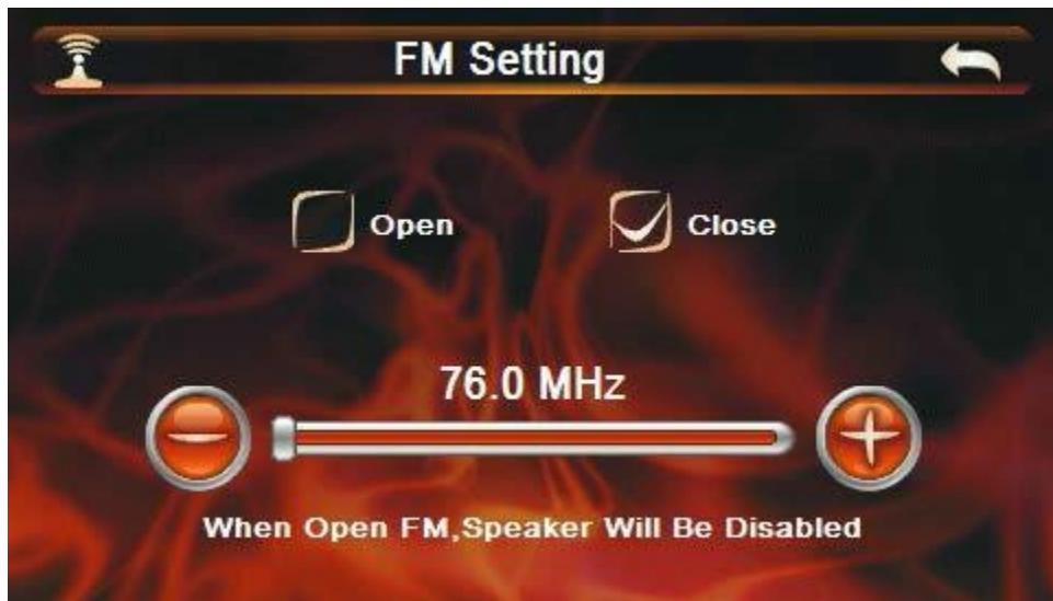
Die Funktion FM Übertragung wird gebraucht, um ein FM Empfang Gerät abzurufen und um Radiosender durch das Navigationssystem wiederzugeben.
