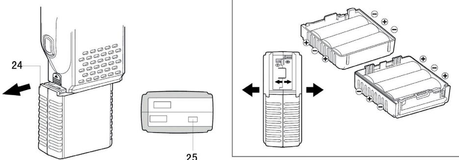
**24. Compartimiento de la batería (accesorio opcional, no incluido): agregue 6 baterías alcalinas de Ni-Cadmio**
