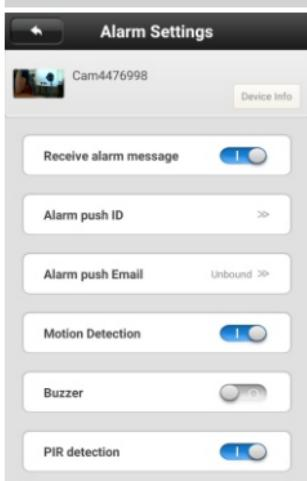
Pentru a utiliza functia de detectie la miscare asigurati-vă ca sistemul este armat (lacatul de sub imagine este inchis, apasati pe el daca apare deschis pentru a-l inchide) apoi activati optiunile din meniul de setari de alarma ca in imaginea alaturata.
