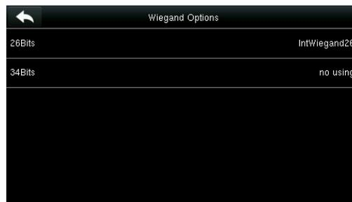
Stellen Sie das Wiegand Format laut Kartei im Gerät ein. Nachdem Sie ein Unikat Wiegand Format benutzen, kann die richtige Zahl der Kartei gelesen werden. Das Wiegand Format kann als IntWiegand 26, IntWiegand 26a, IntWiegand 34, IntWiegand 34a eingestellt werden, so dass die Nummer in einem vorher eingestellten Format ist.
