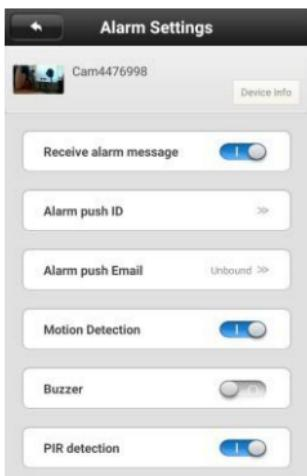
Per utilizzare la funzione di rilevamento del movimento, assicurarsi che il sistema sia inserito (il blocco sotto l'immagine è chiuso, premerlo se appare aperto per chiuderlo), quindi attivare le opzioni nel menu delle impostazioni della sveglia come nell'immagine.
