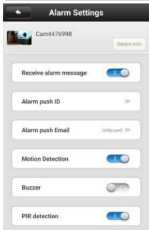
Para usar la función de detección de movimiento, asegúrese de que el sistema esté armado (la cerradura debajo de la imagen está cerrada, presiónela si aparece abierta para cerrarla) luego active las opciones en el menú de configuración de alarma como en la siguiente imagen.
