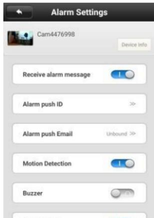
Pour utiliser la fonction de detection au mouvement, le systeme doit etre arme (la serrure sous l'image est fermee, si elle est ouverte, appuyez sur la serrure pour la fermer), ensuite activez les options du menu des reglages de l'alarme conformement a l'image reliee.
