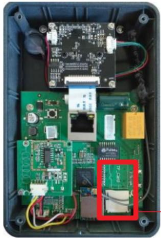
L'unité d'exterieur permet l'enregistrement local des images du camérascope sur une carte de mémoire micro SD, que vous pouvez acheter séparément. Celle-ci supporte les cartes de la 4-me classe ou plus grande et la capacité maximale de 64 GB.
