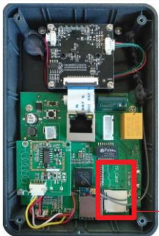
Die äußere Einheit nimmt Bilder auf, die die Video Kamera sendet und speichert sie auf eine Karte MicroSD, die separat geliefert wird. Die Karte trägt Karteien Klasse 4 oder größer und hat eine Höchstkapazität von 64GB.
