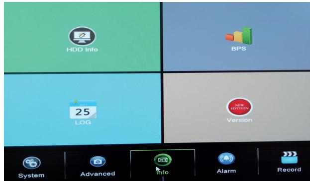
Das Interface bietet detaillierte Infos über das Speichergerät, BPS (zeigt den Übertragungsfluss Kb/s und die Speicherkapazität MB/h in Echtzeit, die Historie und die Software Version.
