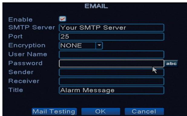
Daca alarma este pornita sau daca legaturile sunt realizate, sistemul va trimite un email cu informatii despre alarma si cu fotografii la adresa setata.
