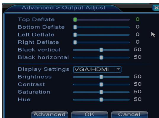
Същият интерфейс може да бъде достъпен, като се влезе в Main menu (Основно меню)-Advanced (Разширени настройки) - Output adjust (Регулиране на изображение)
