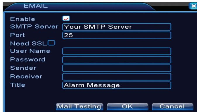
Wenn der Alarm eingeschaltet ist, oder wenn die Verbindungen gemacht wurden, sendet das System eine E-Mail mit Infos über den Alarm und mit Fotos an die eingestellte Adresse.
