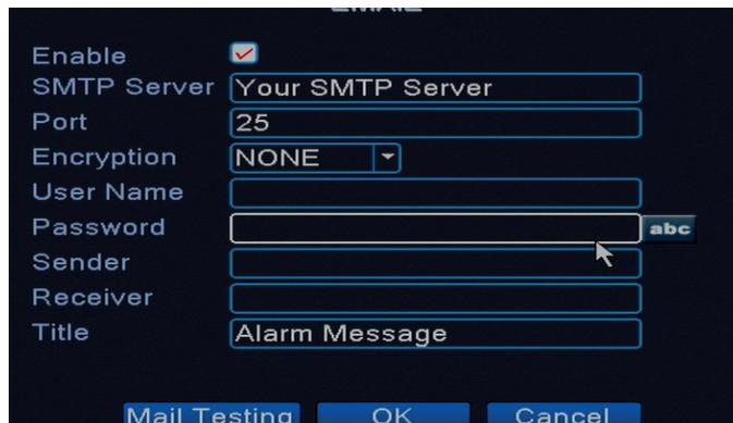
Si la alarma está activada o se han realizado las conexiones, el sistema enviará un correo electrónico con información de alarma y foto a la dirección establecida.
