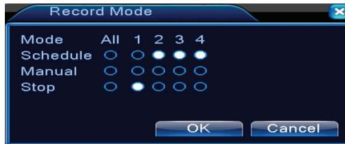
Кратък път до настройката на режима записване на всеки канал. По-подробни настройки относно записването могат да се извършат, като се влезе в Main menu (Основно меню) – Основно меню (Записи) - Record conf (Конфигуриране на записи).
