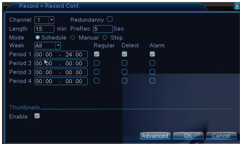
**Channel (Sender):** Wählen Sie die entsprechende Nummer für den Sender, wo Sie aufnehmen möchten. Wählen Sie die Option **All** (Alles), um alle Sender gleichzeitig einzustellen.
