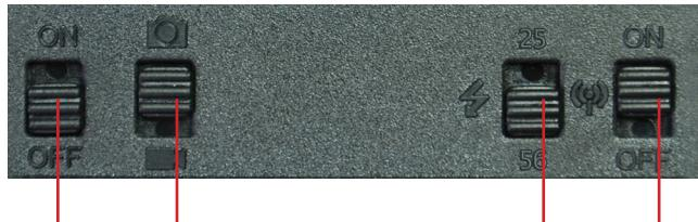
Bouton de démarrage      Bouton photo / vidéo      Bouton Sélectionner LED IR      Bouton GPRS
