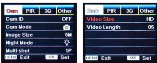
En el modo Prueba, toque el botón "M" una sola vez para entrar en el menú de configuraciones de la cámara. Para navegar por el menú toque los botones "←", "↑", "→", "↓", el botón "OK" para confirmación y el botón "M" para volver al menú anterior.
