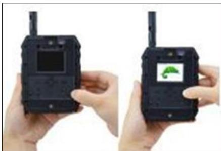
Comute los botones 1 y 4 en la posición "ON", luego toque el botón "OK"; la pantalla LED se iluminará. La cámara buscará automáticamente la señal (la operación toma alrededor de 30-40 segundos), después de lo cual verá la barra de señal que se muestra en la esquina superior izquierda de la pantalla LED.
