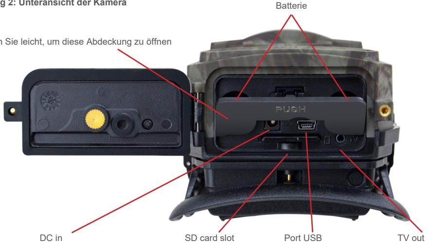
Abbildung 3: Innen-, Seiten- und Rückansicht der Kamera
