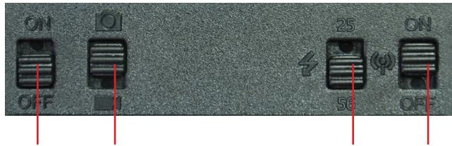
Stromschalter      Kamera / Video-Schalter      IR-LEDs Gruppenschalter      GPRS switch
