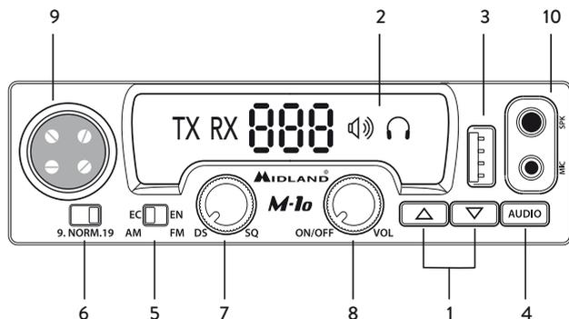
1. **Pulsanti UP/DOWN:** cambio canale. Pressione breve: incremento/decremento canali; pressione lunga: cambio canali veloce.
