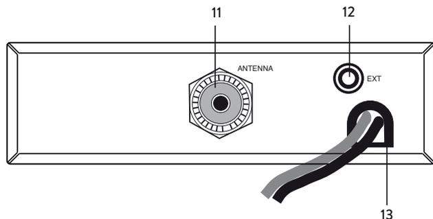
11. **Conector de la antena:** conector tipo PL.
