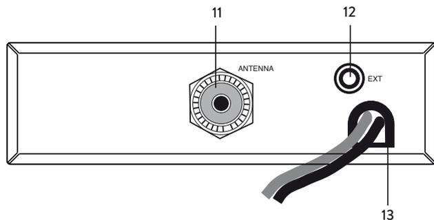
11. **Conector antena:** conectati aici o antena radio CB utilizand o mufa de tip PL.
