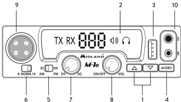
1. **Botones ARRIBA/ABAJO:** selección de canal. Pulsación corta: canal arriba/ canal abajo; pulsación larga: búsqueda rápida de canales.
