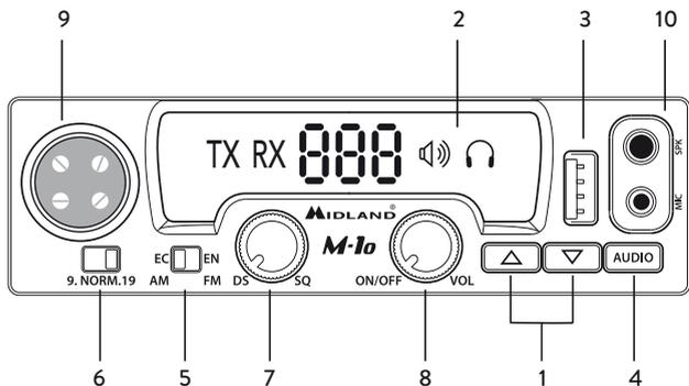
1. **UP/DOWN Taste:** Kanalauswahl. Kurzer Druck: Umschalten der Kanäle; Langer Druck: Schnelles Scrollen der Kanäle.
