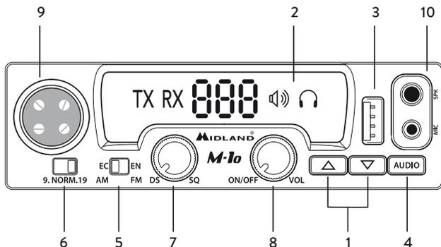
1. **Taste sus/jos:** pentru schimbarea canalului. Apasare scurta: schimbare canal unul cate unul; Apasare lunga: schimbare rapida canal
