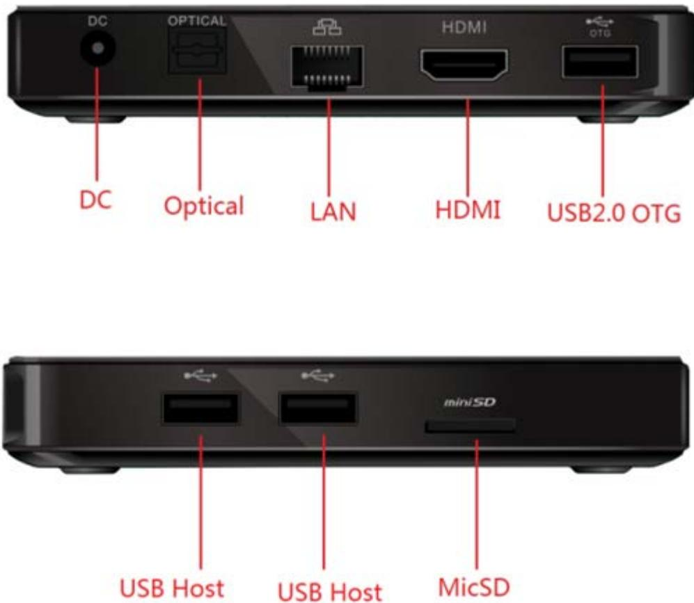
**Port HDMI** – conectati dispozitivul la portul HDMI al unui TV high-definition sau la monitorul unui PC folosind un cablu HDMI
