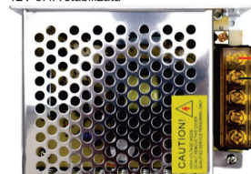
Sursa de tensiune in comutatie PNI ST3.4A 12V 3.4A stabilizata
