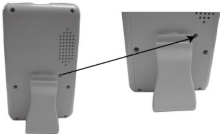
Se foloseste un ac pentru a apasa tasta de imperechere aflata in spatele monitorului. Led-ul de alimentare de pe acesta va incepe sa palpaie confirmand cautaarea camerei. Porniti camera din butonul ON/OFF (Pornire). Led-ul de alimentare va confirma imperecherea oprindu-se din palpait.
