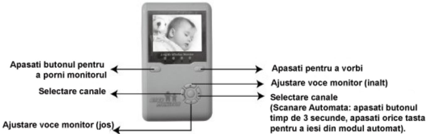
Butonul de pornire de pe camera si monitor se apasa abia dupa ce acestea au fost conectate.
