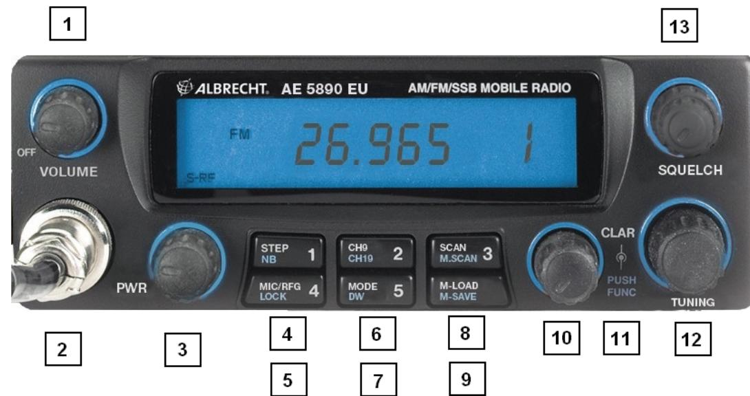
**Potentiometru (1) Pornit/Oprit + Volum** – Rotiti butonul (1) spre dreapta si astfel el Porniti statia, apoi reglati volumul dorit
