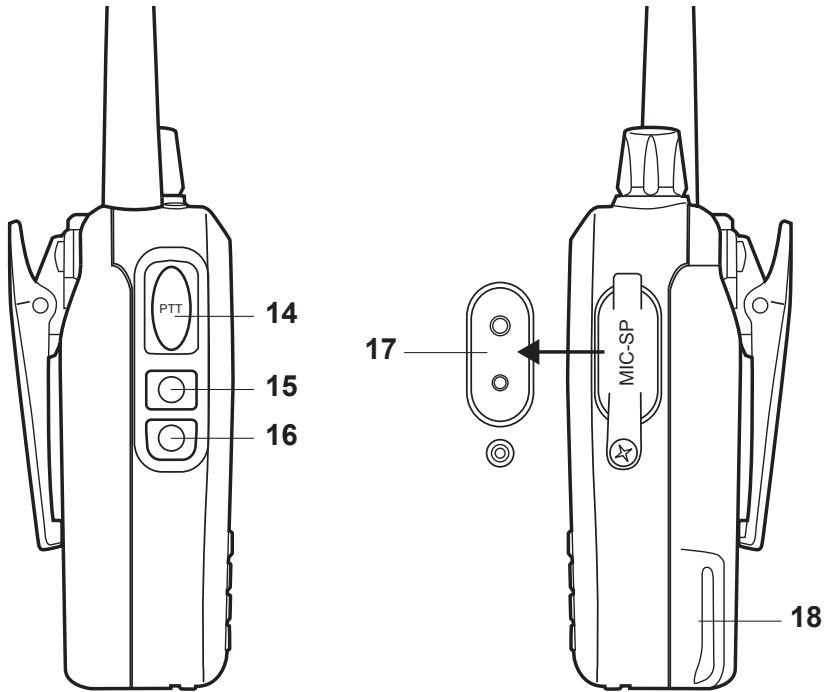
14. **PTT:** premerlo per trasmettere (il led si illumina di rosso) e rilasciarlo per ricevere (led verde).
