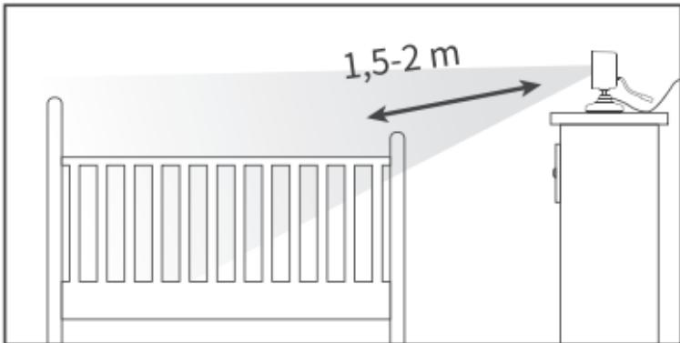
Vous pouvez installer la caméra sur une surface horizontale plane ou sur le mur à l'aide des chevilles incluses dans l'emballage.
