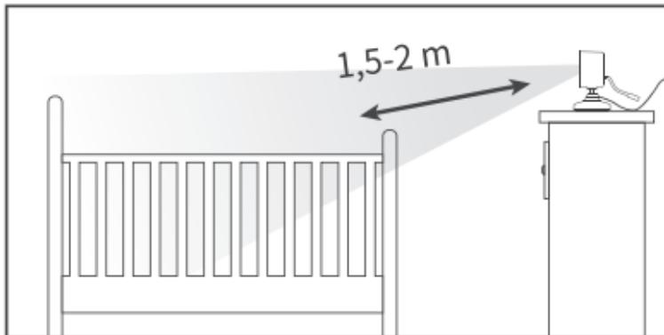
U kunt de camera op een vlak horizontaal oppervlak of aan de muur installeren met behulp van de meegeleverde pluggen.
