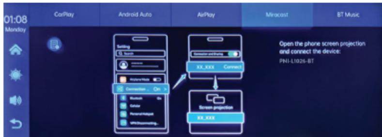
Podłącz telefon z systemem Android do sieci Bluetooth „PNI-D1026-BT” i do lokalnej sieci Wi-Fi „PNI-D1026-WiFi” generowanej przez system multimedialny. Hasło Wi-Fi: 12345678.
