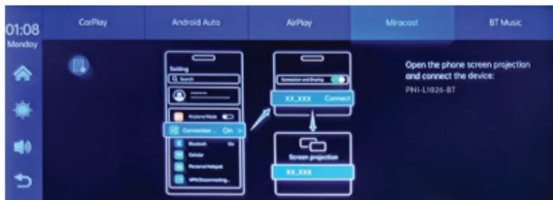
Collega il telefono Android alla rete Bluetooth “PNI-D1026-BT” e alla rete Wi-Fi locale “PNI-D1026-WiFi” generata dal sistema multimediale. Password Wi-Fi: 12345678.
