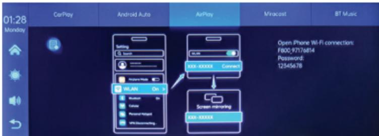
Verbind de iPhone met het lokale Wi-Fi-netwerk “PNI-D1026-WIFI” dat door het multimediasysteem is gegenereerd. Netwerkwachtwoord: 12345678.
