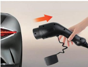
Haal de connector uit de aansluiting van de elektrische auto wanneer het opladen succesvol is voltooid.
