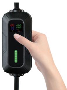
Nyomja meg a hordozható töltőállomás érintőgombját 3 másodpercig. A tápellátás jelzőfénye villogni fog. Nyomja meg röviden az érintőgombot a töltési áram és idő beállításához.
