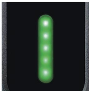
Diody LED na panelu przednim wskazują stan ładowania.
