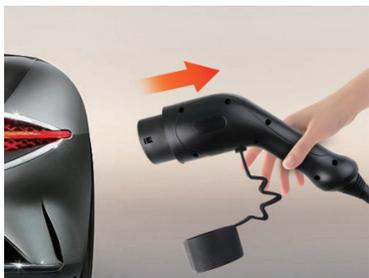
Entfernen Sie den Stecker aus der Steckdose des Elektroautos, wenn der Ladevorgang erfolgreich abgeschlossen ist.
