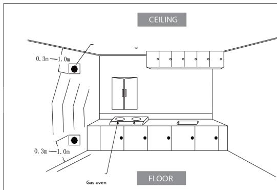
3. Fissare saldamente le viti alla parete, quindi appendere il rilevatore di gas.
