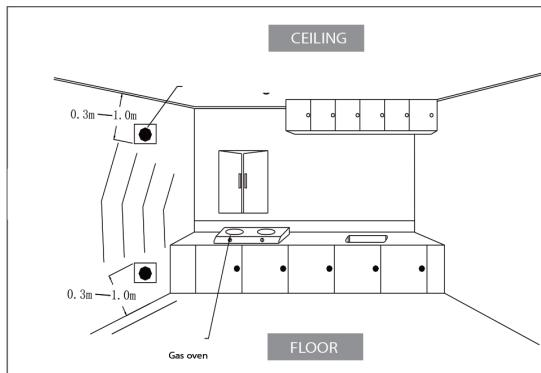
3. Vissez fermement les vis dans le mur, puis suspendez le détecteur de gaz.
