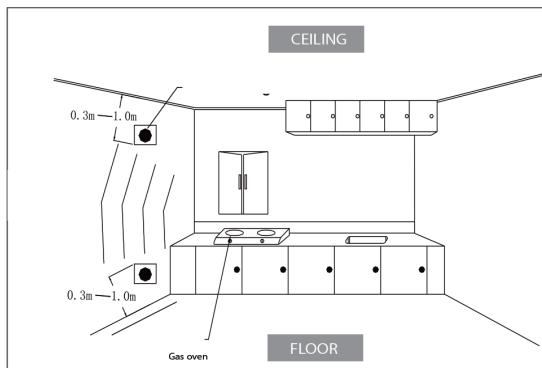
3. Draai de schroeven stevig in de muur en hang de gasdetector op.
