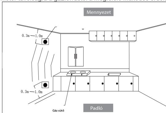
4. Biztosítson csavarozott felszerelést a falon az eszköznek, majd helyezze fel azt a falra.
