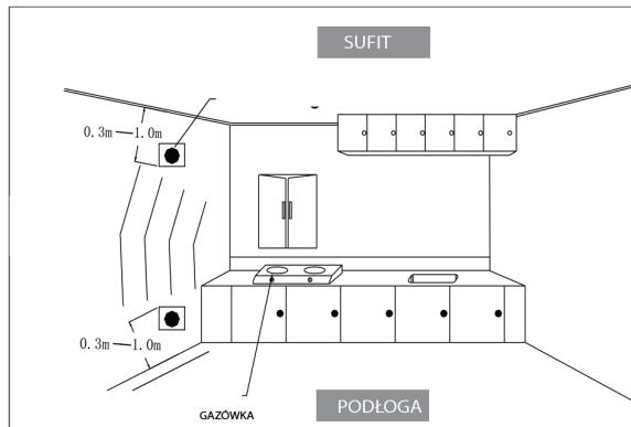
3. Przykręć mocno śruby do ściany, a następnie umieść czujnik gazu.
