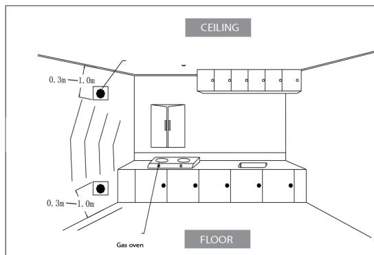
3. Befestigen Sie die Schrauben fest in der Wand und hängen Sie dann den Gasdetektor auf.
